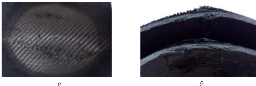
Рис. 6. Фотографии пластинки композиционного материала после испытания
