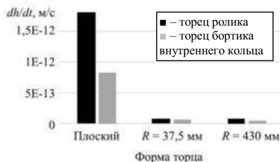
Рис. 9. Скорость износа торцов ролика и борта внутреннего кольца для разных вариантов профиля торца борта (вариант 48)
