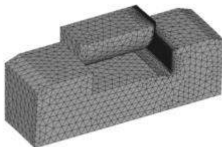
Рис. 4. Общий вид конечно-элементной модели контактного взаимодействия торца ролика и борта внутреннего кольца
