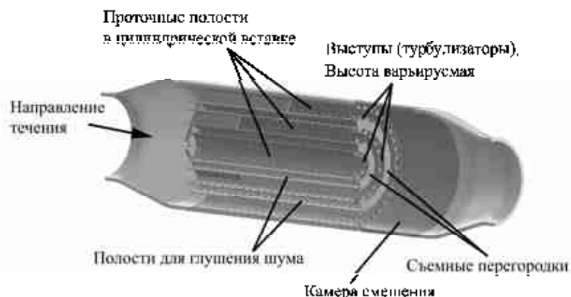
Рис. 1. Схема проточной части устройства подготовки потока
